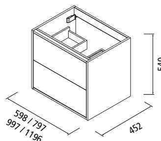
El modelo de 1196mm se conforma con 2 muebles de 598mm.
