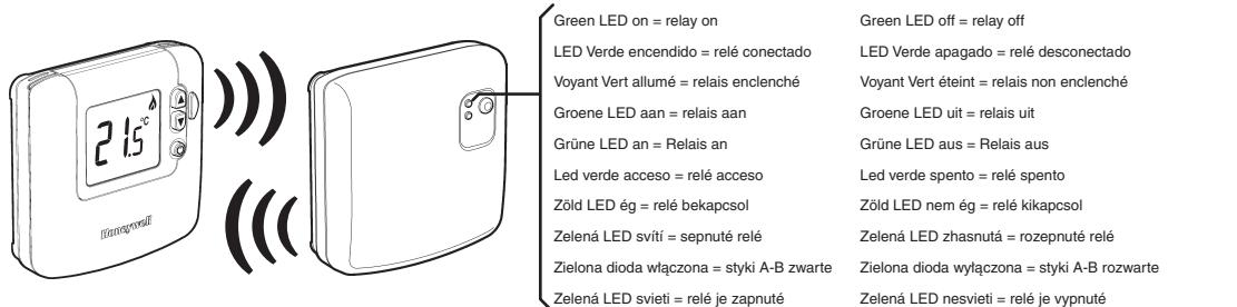
Temporary Manual Override / Anulación Manual Temporal / Dérogation manuelle temporaire / Tijdelijk handmatige bediening / Temporäre manuelle Änderung / Forzatura temporanea manuale / Kézi felülvezérlés / Přechodné manuální potlačení funkce / Sterowanie ręczne przekaźnikiem modułu kotłowego / Dočasná manuálna prevádzka
