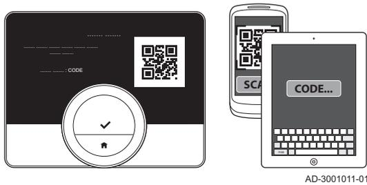
9. Introducir el código de registro en la aplicación o escanear el código QR con el dispositivo móvil.
