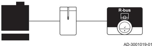
Si el generador no incluye el protocolo R-bus, necesitará una pasarela para conectar el termostato al generador. En ese caso, la pasarela ofrece tres protocolos de comunicación:
