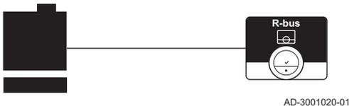
Si el generador de calefacción incluye el protocolo R-bus, puede conectar el termostato directamente al generador. El generador y el termostato presentarán el máximo número de funciones con este protocolo.
