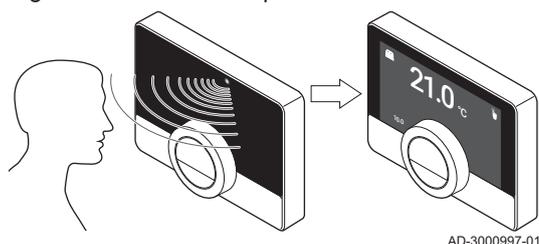
La pantalla de inicio se iluminará (durante 5 segundos) cuando la sonda de presencia detecte que alguien está situado delante del termostato o ha pasado frente a él. Puede desactivar la sonda de presencia en el menú de ajustes.
